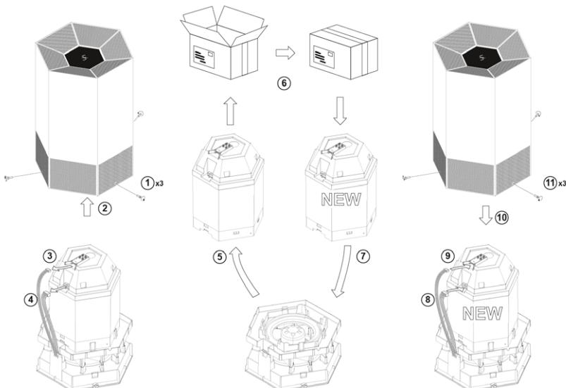
1. Enlever les 3 vis dans le sens inverse des aiguilles d'une montre.
